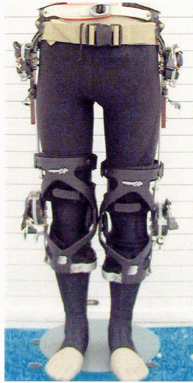
Lower-extremity exoskeleton. (Gabriel Ollinger, w. Honda Res. Inst.)
